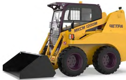
МКСМ 1200М ДВС Д243S2 Мощность ДВС 81,6 л.с. Грузоподъемность - 1200 кг Объем ковша - 0,7 м3
