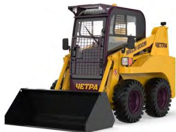
МКСМ 800М ДВС MMZ-4DT Мощность ДВС 63 л.с. Грузоподъемность - 800 кг. Объем ковша - 0,46 м3
